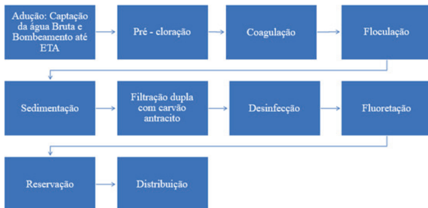
Figura 2 – Etapas do processo de tratamento de água na ETA AEGEA/CORSAN do Município do COREDE Missões - RS
