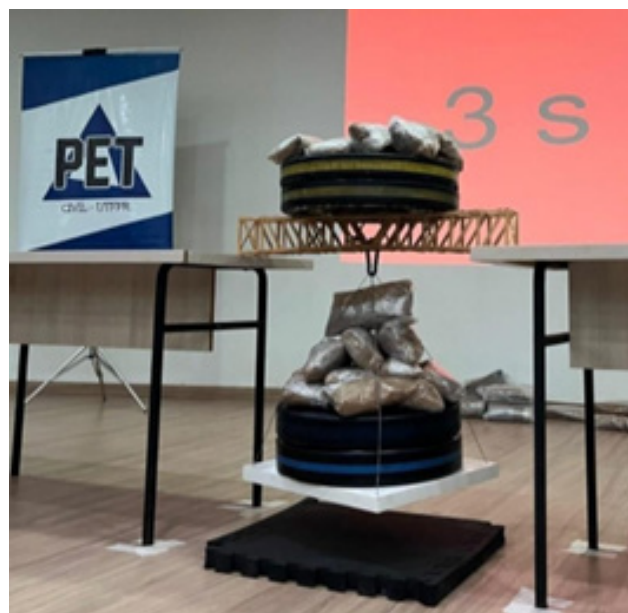
Figura 5 - Ponte de palito durante a ruptura
