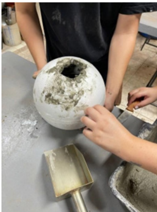
Figura 1 - Execução de esfera de concreto
