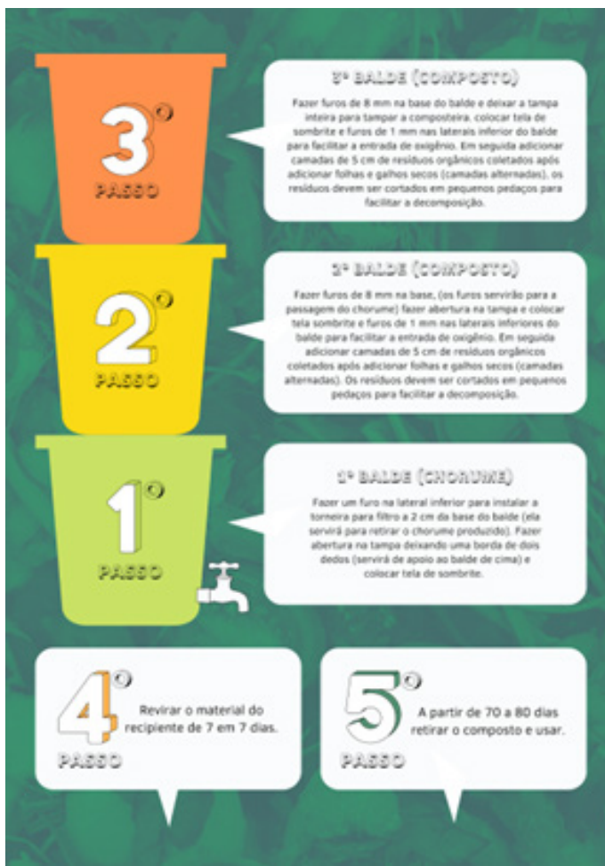
Figura 8 - Técnica de construção da composteira.
